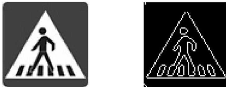
Fig3. Sobel edge detection.
