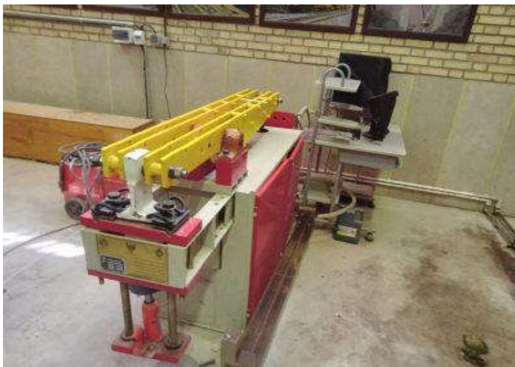
آزمایشگاه روسازی: تست خستگی پابند
