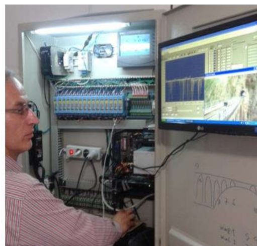
اندازه گیری بار محوری در حال حرکت قطار در ایستگاه بهرام
