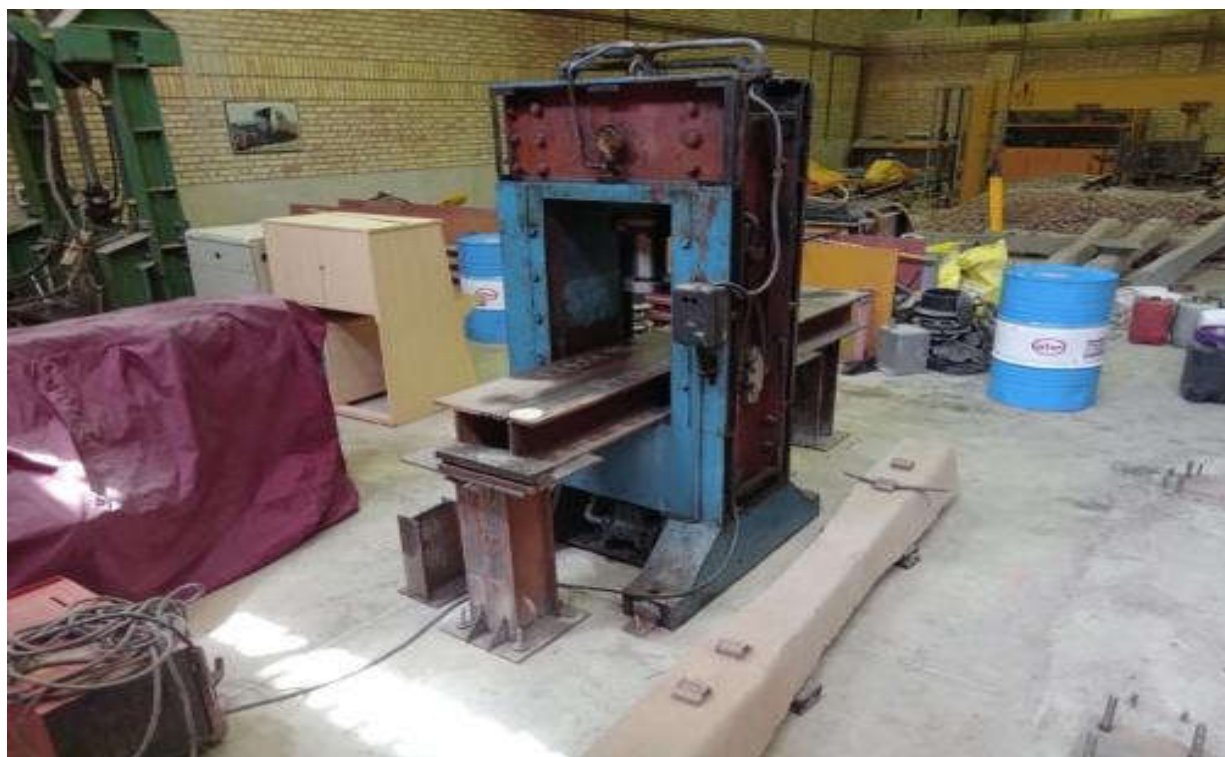
آزمایشگاه روسازی: آزمایش های خمش مثبت و منفی تراورس های بتنی
