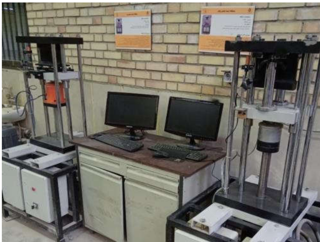
آزمایشگاه روسازی: تست سختی پد و پابند خطوط ریلی
