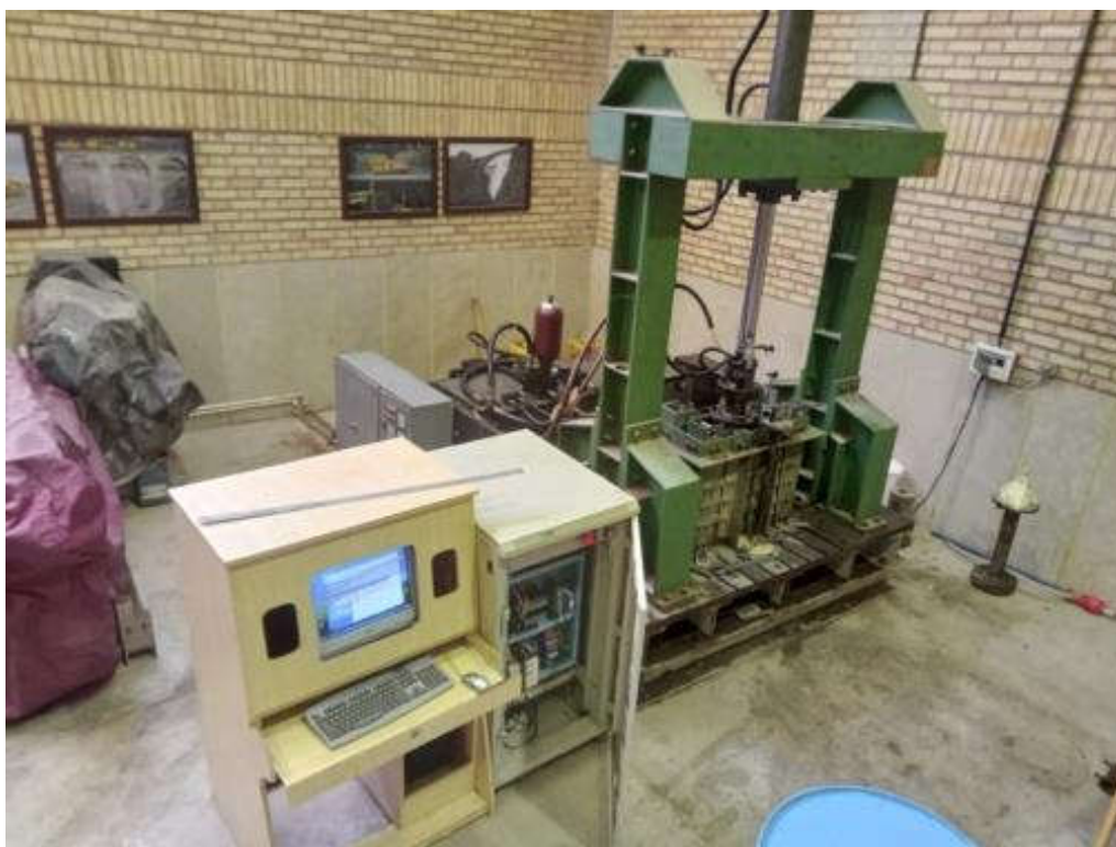
آزمایشگاه روسازی: دستگاه جعبه بالاست جهت تست انواع بالاست تحت بار سیکلیک
