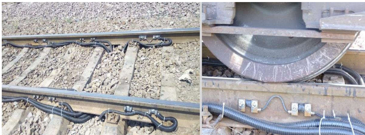
اندازه گیری بار محوری در حال حرکت قطار در ایستگاه بهرام
